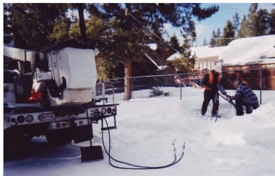
Sursa de putere hidraulica de la o macara pentru repararea firelor electrice.
